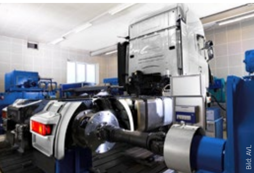
Ein Lkw am e-Achs-Prüfstand bei AVL in Steyr
