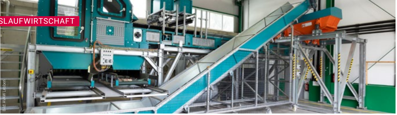
Sensorbasierte Sortieranlage im Digital Waste Research Lab in St. Michael in der Obersteiermark
