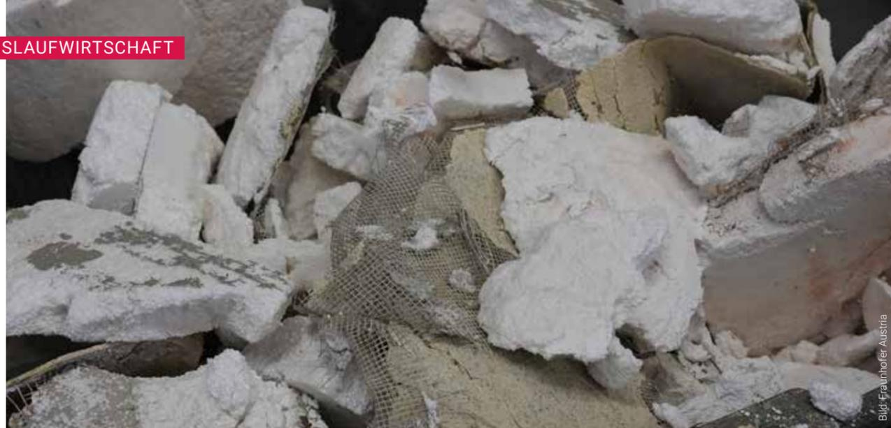
Probenmaterial aus maschinellem Rückbau eines Wärmedämmverbundsystems (WDVS)
