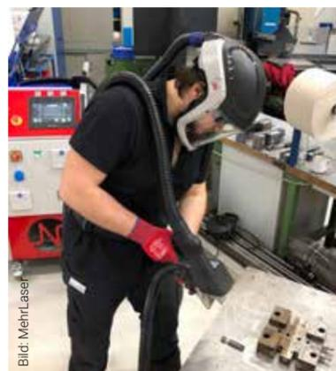
Mit Lasertechnologie gegen Rost und andere Oberflächenverunreinigungen
