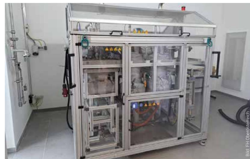
Der entwickelte Batchreaktor zeigt an, ob sich ein Inputmaterial für das chemische Recycling eignet.
