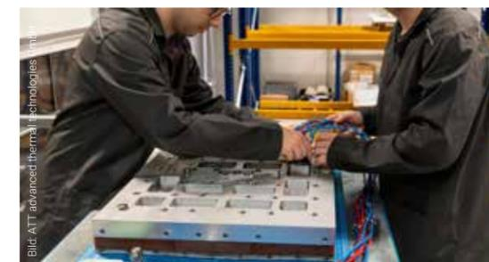
ATT fertigt Heizplatten für Tiefziehverpackungsmaschinen.
