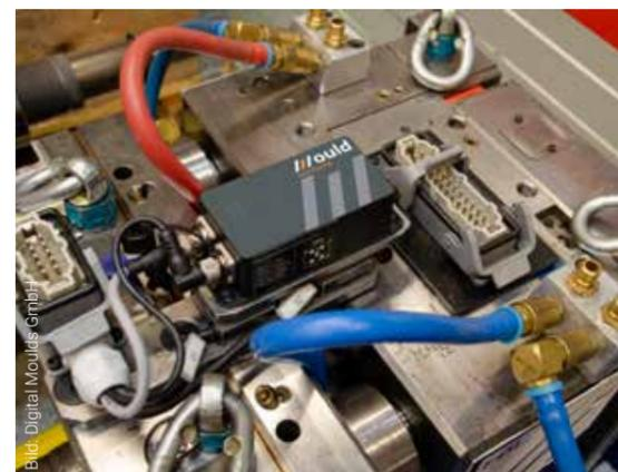
Mould Monitoring, ein innovatives Werkzeugüberwachungssystem
